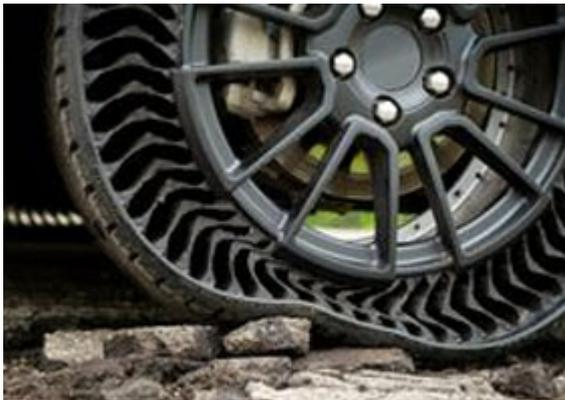
Cette année, Michelin a dévoilé une innovation qui a toutes les chances d'équiper les véhicules de demain : il s'agit d'un pneu sans air comprimé. Développé en partenariat avec General Motors, ce pneu alvéolaire sans chambre à air devrait être commercialisé à partir de 2024.
