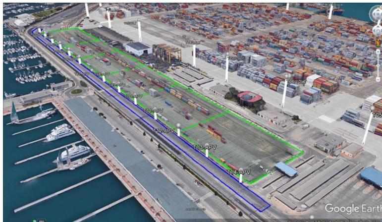
Comme le montre l'image, la gare de triage (zone verte) est actuellement faiblement éclairée avec les poteaux d'éclairage de la gare des conteneurs. L'objectif est de remplacer les poteaux d'éclairage des routes (zone bleue) par un système d'éclairage dynamique, qui reçoit les données du terminal pour modifier le degré d'éclairage. Le système d'éclairage dynamique repose sur la position GPS de l'équipement portuaire de Noatum et sur des capteurs à longue portée (capteurs de présence).
