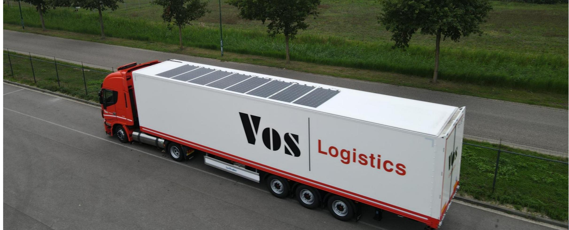
**Vos Logistics, l'un des principaux fournisseurs de services logistiques aux Pays-Bas a eu l'idée d'installer 8 panneaux solaire sur l'une de ses remorque Développé par la société IM Efficiency, ce système photovoltaïque va alimenter en électricité verte le camion et les équipements du semi-remorque.**
